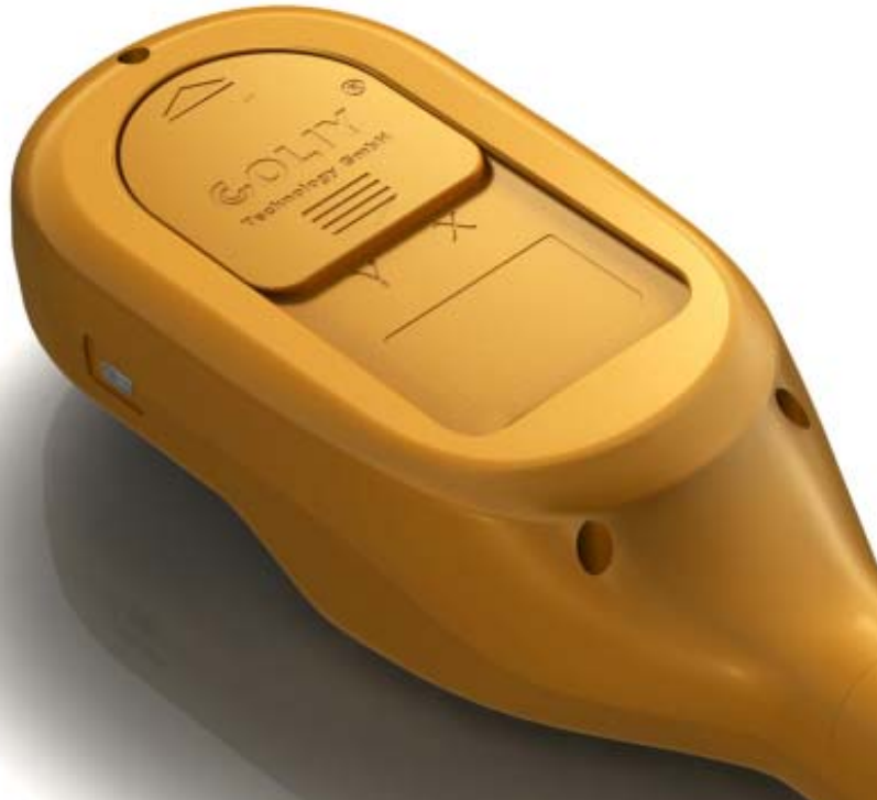
スライドを閉じることにより、センサーは二重に保護され、ガンマ線とX線の測定が可能
